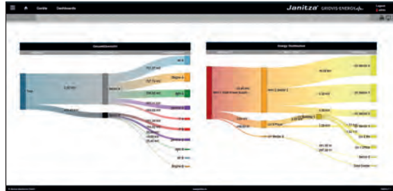
Das Sankey-Diagramm bietet die Möglichkeit, Mengenflüsse grafisch darzustellen. Alle Abb.: Janitza electronics GmbH
