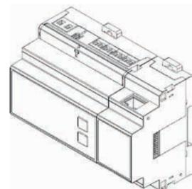
4. Befestigen Sie das Gerät zusammen mit dem Modul an der Ober- und Unterseite mit der Klemme.
