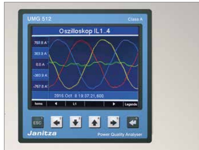
Bild 11: Nichtlineare Lasten führen zu Harmonischen und Rückspeisungen. Die Messung zeigt, wie sich diese auf dem Neutralleiter (Grün) addieren.
