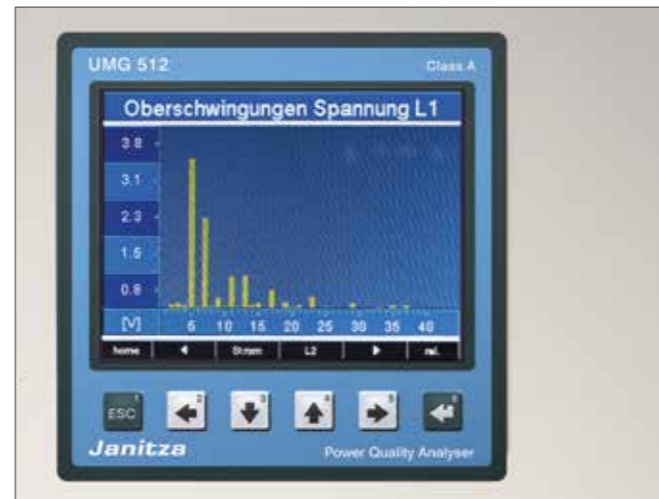
Bild 12: Das UMG 512 kann Harmonische detailliert erfassen und darstellen: hier die 5, 7, 11 und 13 Oberschwingung.
