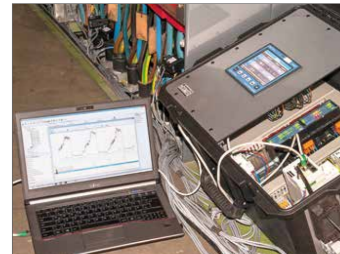
Bild 10: Die mobile Messbox erlaubt dank offener Schnittstellen viele Möglichkeiten zur Auswertung und Dokumentation. Hier wird ein Lastgang direkt am Notebook sichtbar gemacht.
