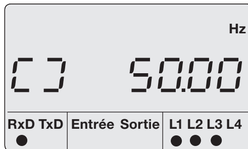
Fig. 19.2 Exemple d'affichage pour le champ magnétique rotatif et la fréquence.
